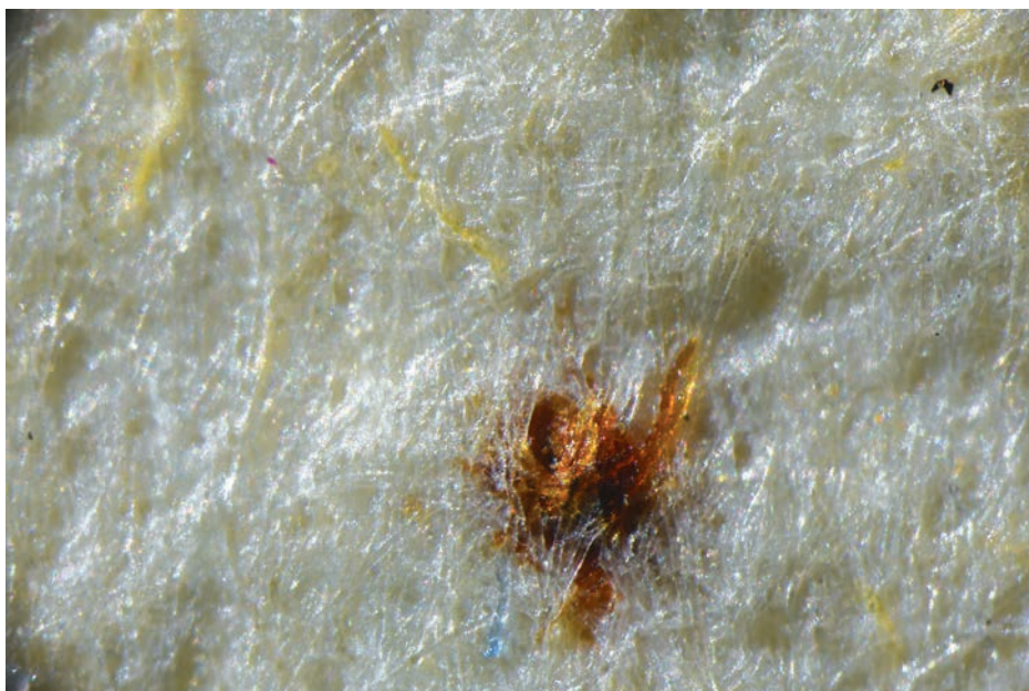
Il. 21 – Papier o sygn. 1669 w powiększeniu mikroskopowym \times 130 . Widoczne małe fragmenty rdzy, niezauważalne gołym okiem. Fot. W. Liszewska
