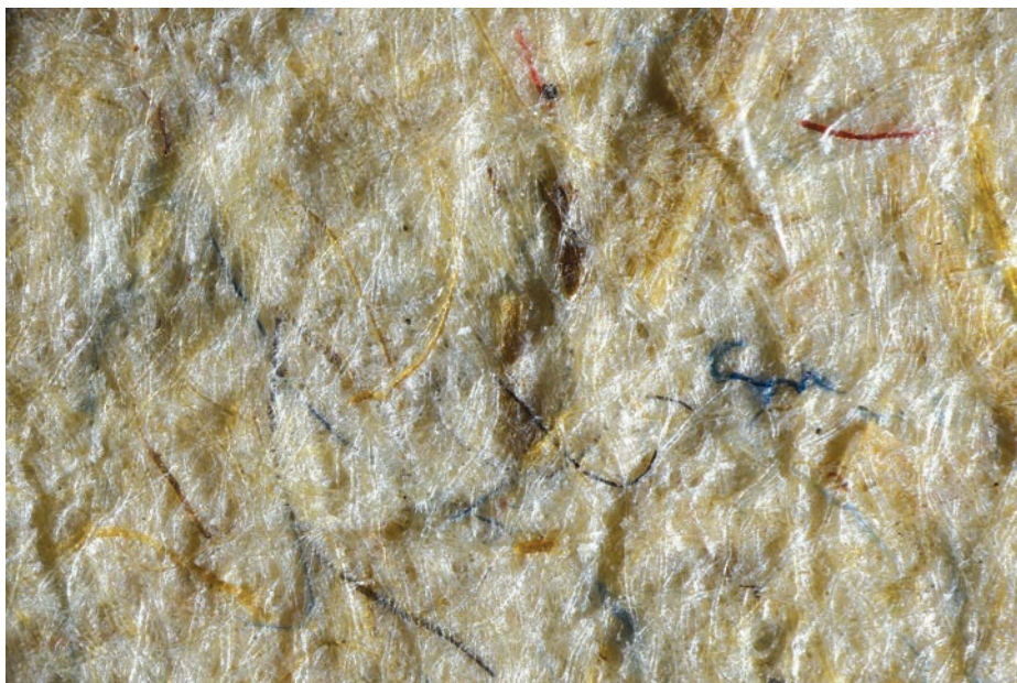
Il. 15 – Papier o sygn. 1659 w powiększeniu mikroskopowym \times 130 . Widoczne włókna o zróżnicowanej kolorystyce. Fot. W. Liszewska
