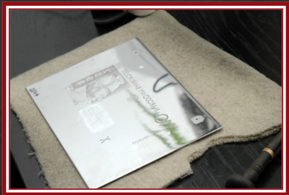
Przenoszenie rysunku projektanta na metalową matrycę, zdjęcia ze zbiorów Polskiej Wytwórni Papierów Wartościowych.
