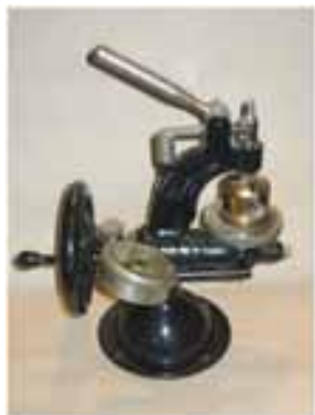
Aparatura laboratoryjna: aparat do oznaczenia przepuklenia papieru ok. 1930 aparat do oznaczenia oporu przedarcia papieru typu Elmendorf 1925
